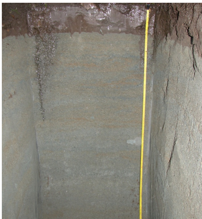
Figur 3: Vertikalsnitt av jordprofil med utskiftede masser på Tiller. Grusholdig siltig grovsand (hovedfraksjon 0,6-2 mm). Vått topplag og vannutslag mot sjiktgrense. Ingen rotutvikling under topplag. Jordtetthet på 1,7 kg/L. Foto: Trond Knapp Haraldsen.
